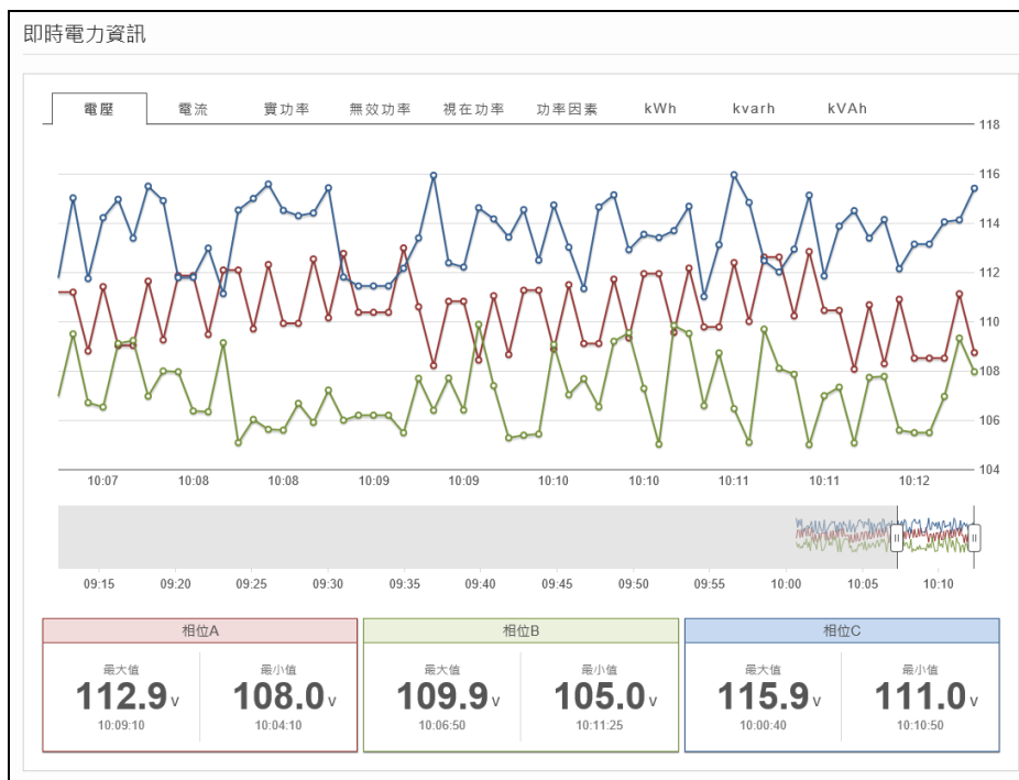
圖7-5: 即時資訊顯示—電錶迴路即時資料趨勢圖顯示
